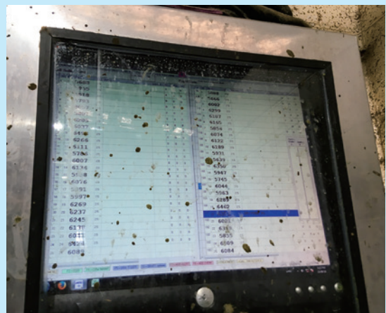
コラム2-写真8 ミルクパーラー内に設置されていた管理データのモニター。ここで、個体ごとの搾乳量などを管理している。病歴があると色がつく
