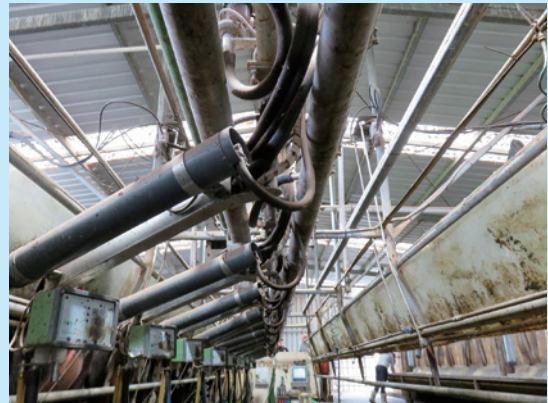
コラム2-写真5、写真6 スイングアーム式のミルクパーラー。牛を入れ替えるごとに、ミルカーのアームを逆側にスイングさせる
